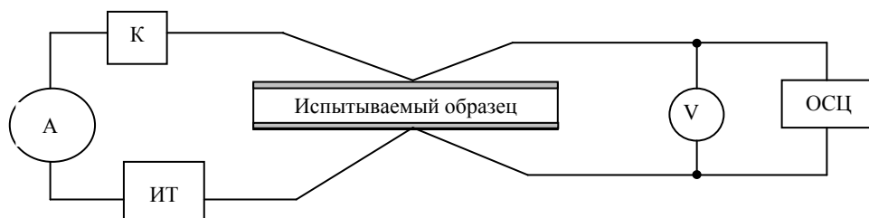
Рис. 3. Схема подключения образца к контрольной и измерительной аппаратуре:
